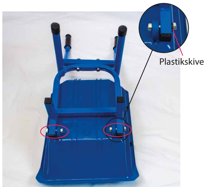
Sæt laddet fast på stellet. Brug 2 plastikskiver, 2 skruer og 2 møtrikker til at sætte laddet fast.
