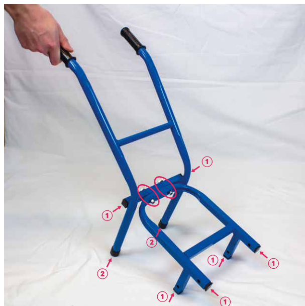
Start med at samle stellet til trillebøren. Sæt de 2 metaldele sammen med 2 skruer. Sæt de 6 medfølgende firkantede plastikpropper i de 6 forskellige huller ① i stellet. Sæt de 2 runde plastikpropper i bunden ② af stellet.
