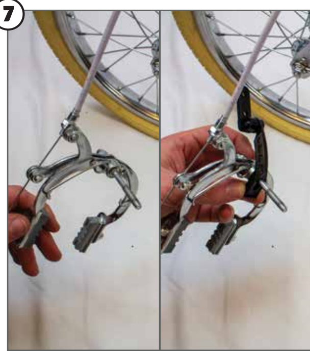
7 Afmonter forbremsen, for at monter holderen til den hvide refleks på bremsearmene. Monter derefter bremsearmene på forgafflen. Sørg for, at bremsene er spændt, inden cyklen tages i brug.
