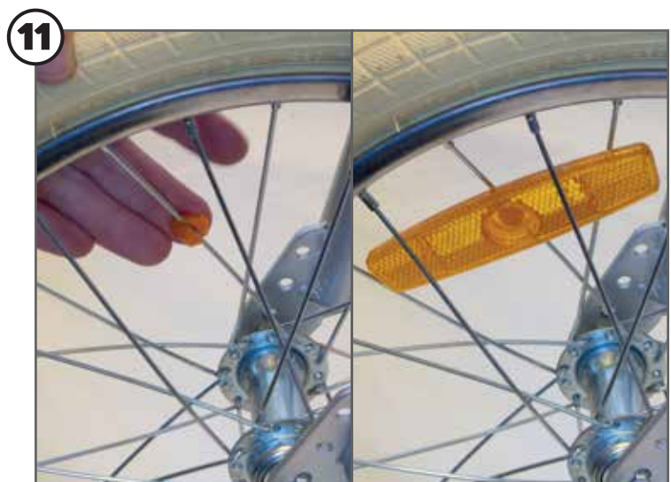
11 Monter 1 refleks i hvert hjul, imellem egerne. Sæt først den lille orange lås på ydersiden, sæt dernæst refleksen på låsen, og drej låsen for at få refleksen til at sidde fast.
