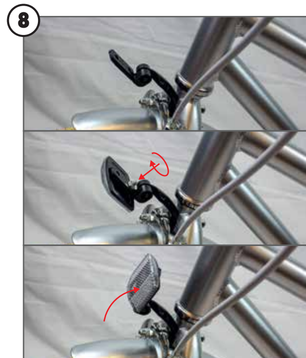
8 Monter den hvide refleks på holderen. Sørg for, at den peger fremad, så den kan ses.
