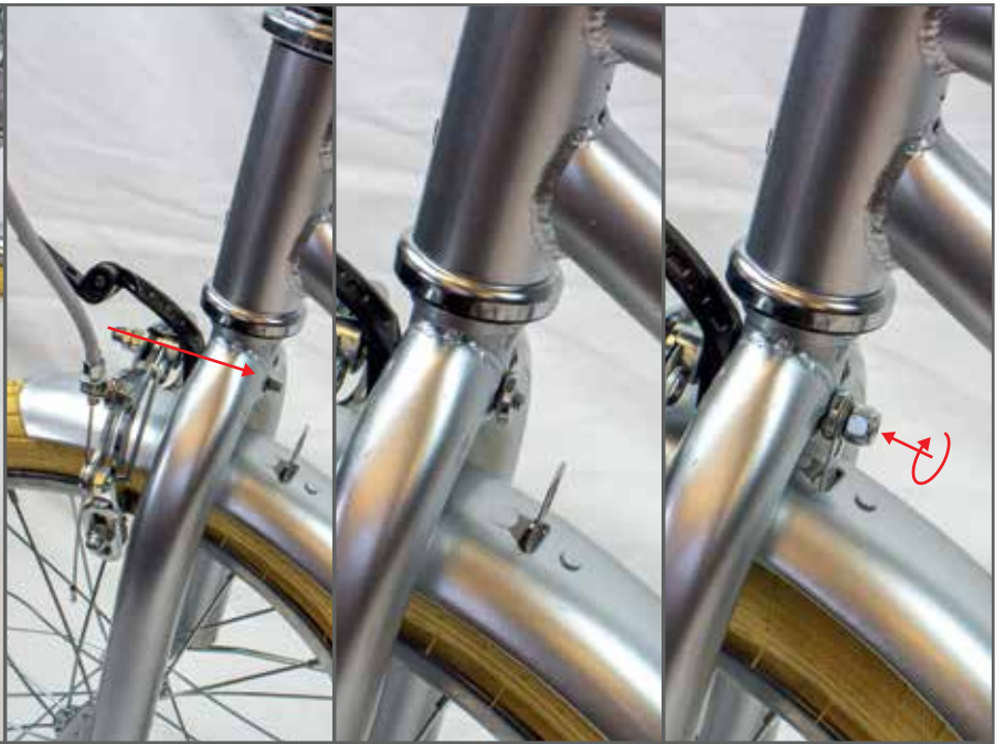
7 Afmonter forbremsen, for at monter holderen til den hvide refleks på bremsearmene. Monter derefter bremsearmene på forgafflen. Sørg for, at bremsene er spændt, inden cyklen tages i brug.
